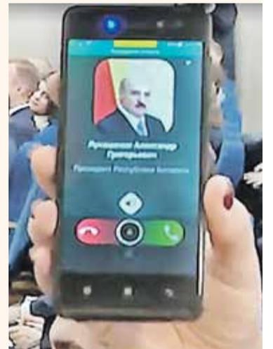
По его словам, используется разработка криптографов КГБ, она не позволяет прослушать разговор - речь кодируется. Если кто-то перехватит эфир, то услышит лишь булькающие звуки. Дешифровка происходит только при получении сигнала на другом таком же аппарате. Из-за этих особенностей устройство довольно массивное. Спецы работают над тем, чтобы сделать его компактнее.
